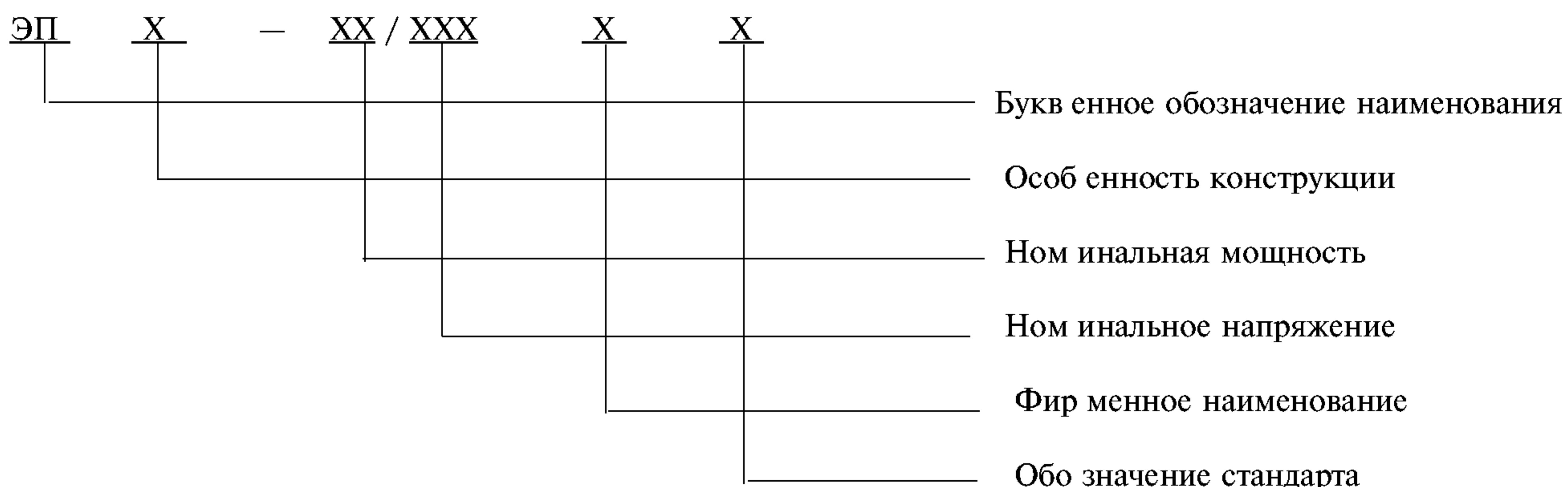
Пример условного обозначения погружного электрокипятильника номинальной потребляемой мощностью 1,0 кВт, номинальным напряжением 220 В, с термовыключателем, модели «Электро»:
