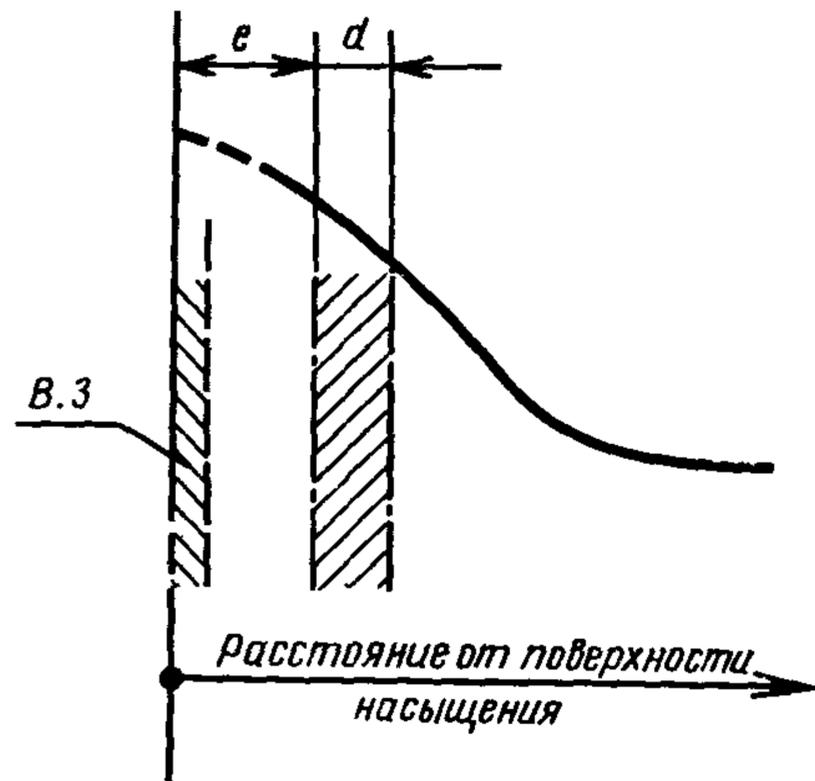
$d$  — толщина зоны (мерного участка) диффузионного слоя;  $e$  — глубина залегания зоны (мерного участка) диффузионного слоя; *В. З.* — внешняя зона диффузионного слоя.
