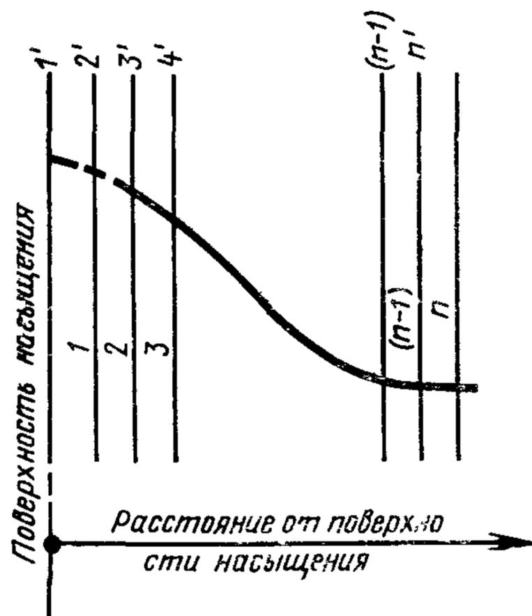
1, 2, 3 (n-1) n — номера участков диффузионного слоя, последовательно удаляемых и исследуемых по составу,
