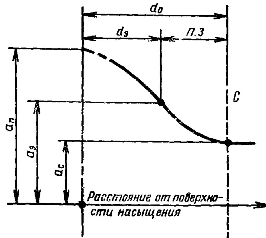
*П З* — переходная зона диффузионного слоя; *С* — сердцевина,  $d_0$  — общая толщина диффузионного слоя,  $d_э$  — эффективная толщина диффузионного слоя;  $a_п$  — значение базового параметра у поверхности;  $a_э$  — предельное значение базового параметра, установленное для эффективной толщины;  $a_с$  — значение базового параметра сердцевины.
