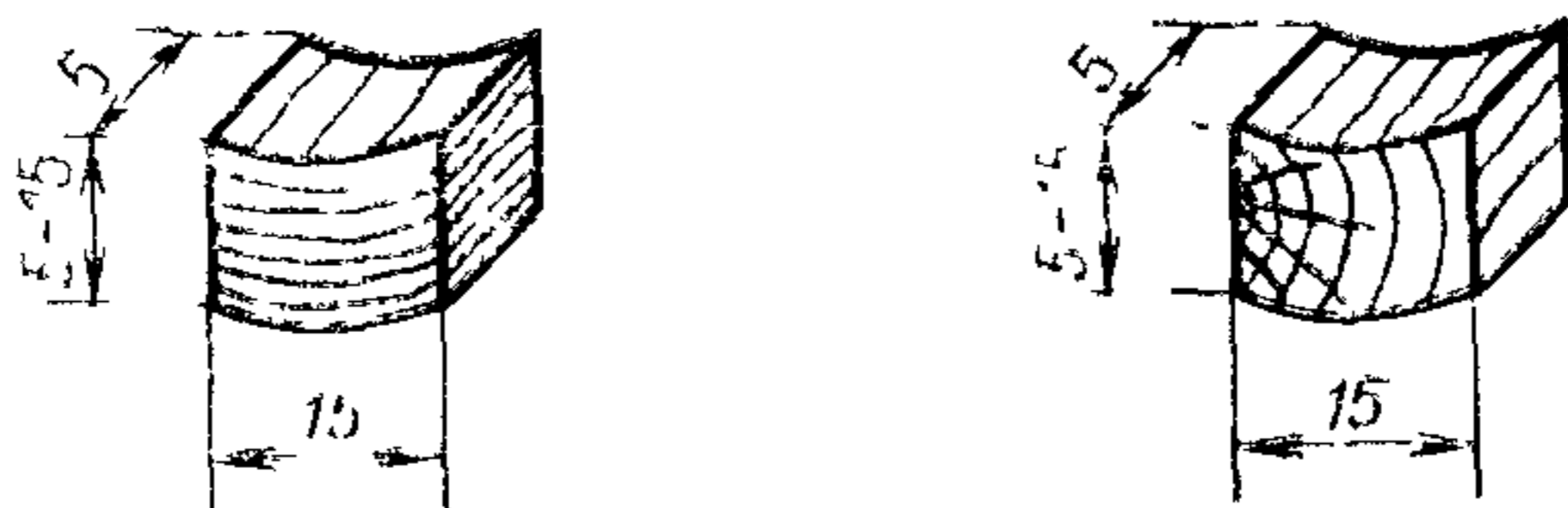
а—образцы из втулок марки ДМТМ КПИ и ДМТМ-РНИ по ГОСТ 9629—81 б—образцы из втулок марки ДМТМ ГПТ по ГОСТ 9629—81
