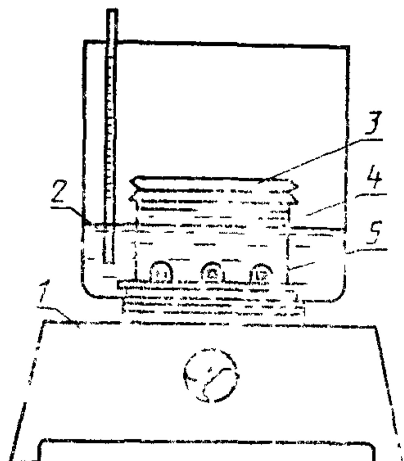
1—нагревающее устройство; 2—водяная или масляная баня; 3—полимерная пленка, закрепленная с помощью эластичного шнура; 4—химический стакан, содержащий раствор двуххлористой меди, 5—образец для испытаний
