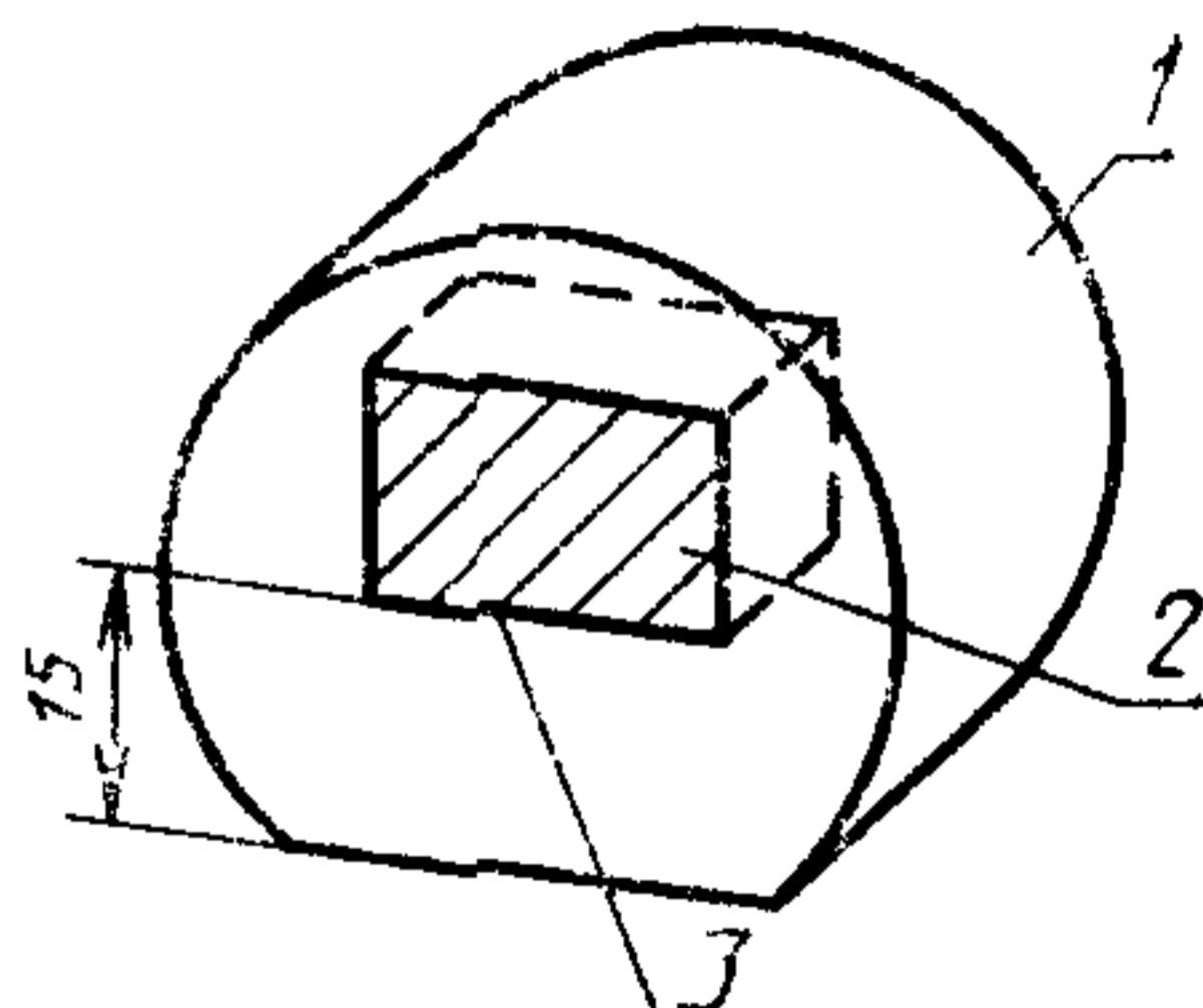
1—фенольная смола или эквивалентный ей материал, 2—отшлифованная испытуемая поверхность, 3—образец
