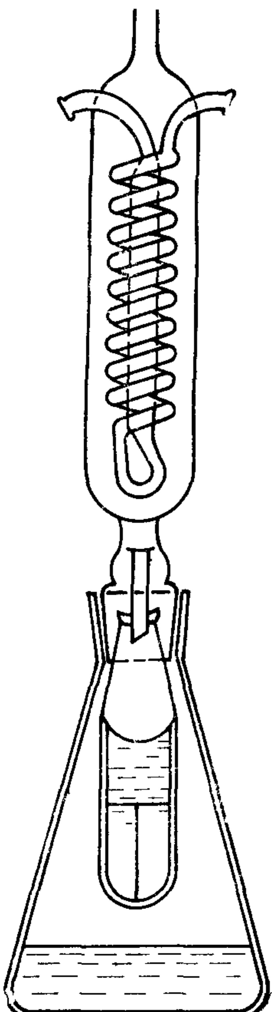
1.5.2. Насадка перегонная Холодильник со шлифом 40/30 для соединения с муфтой конической колбы.
