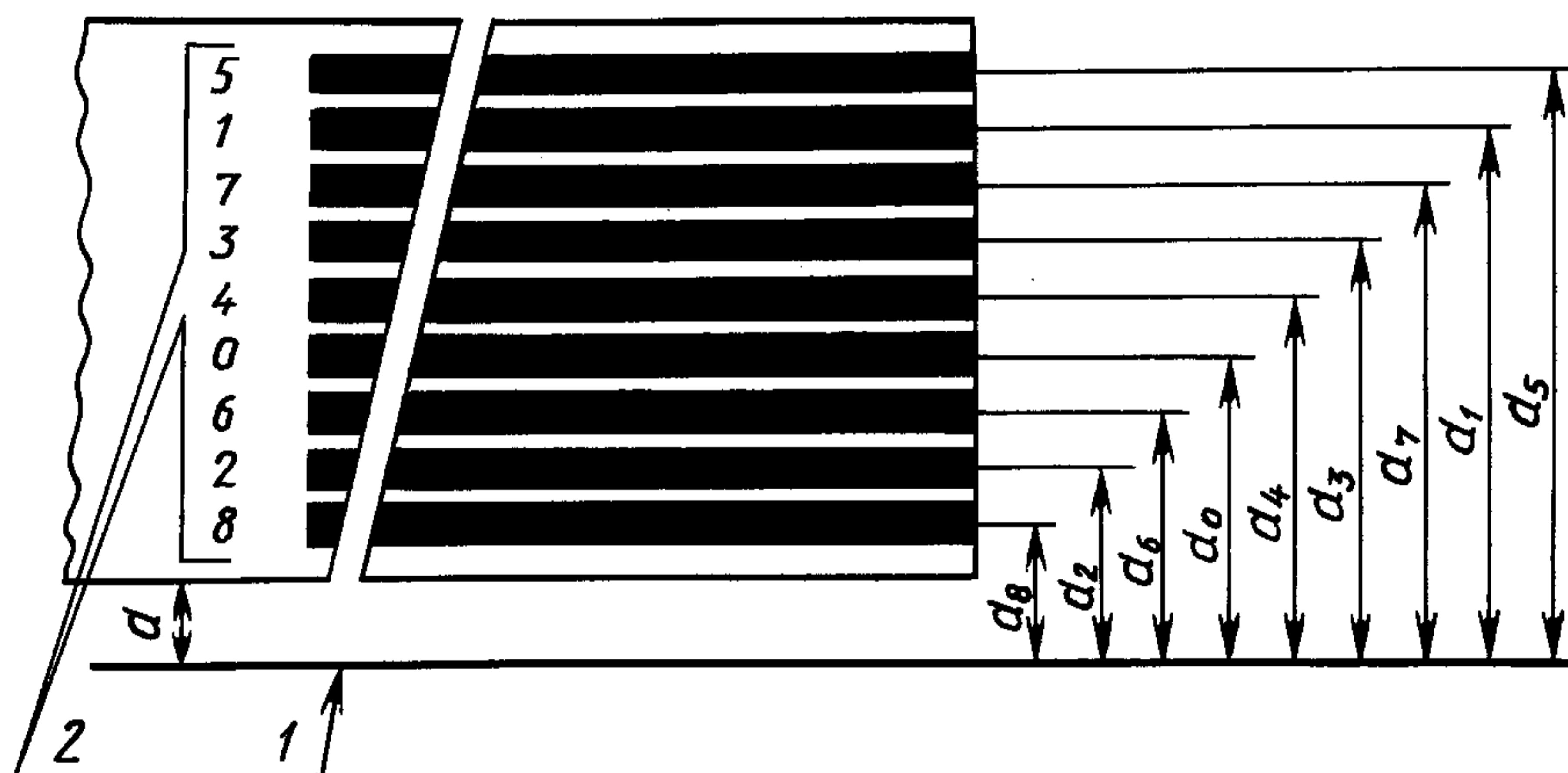
1 — опорная плоскость *B*; 2 — обозначение номеров дорожек
