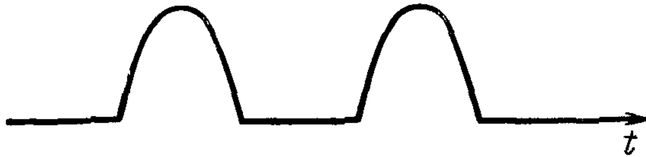
Вид испытательного несимметричного сигнала. Частота 1000 Гц.
