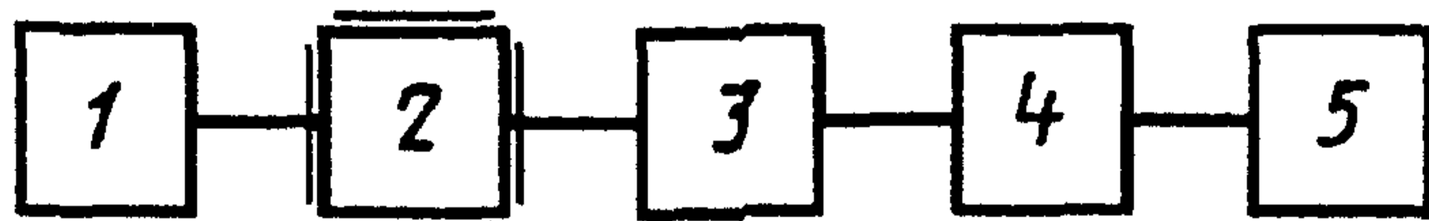
1 — низкочастотный генератор сигналов; 2 — передатчик; 3 — эквивалент антенны; 4 — аттенуатор; 5 — частотомер
