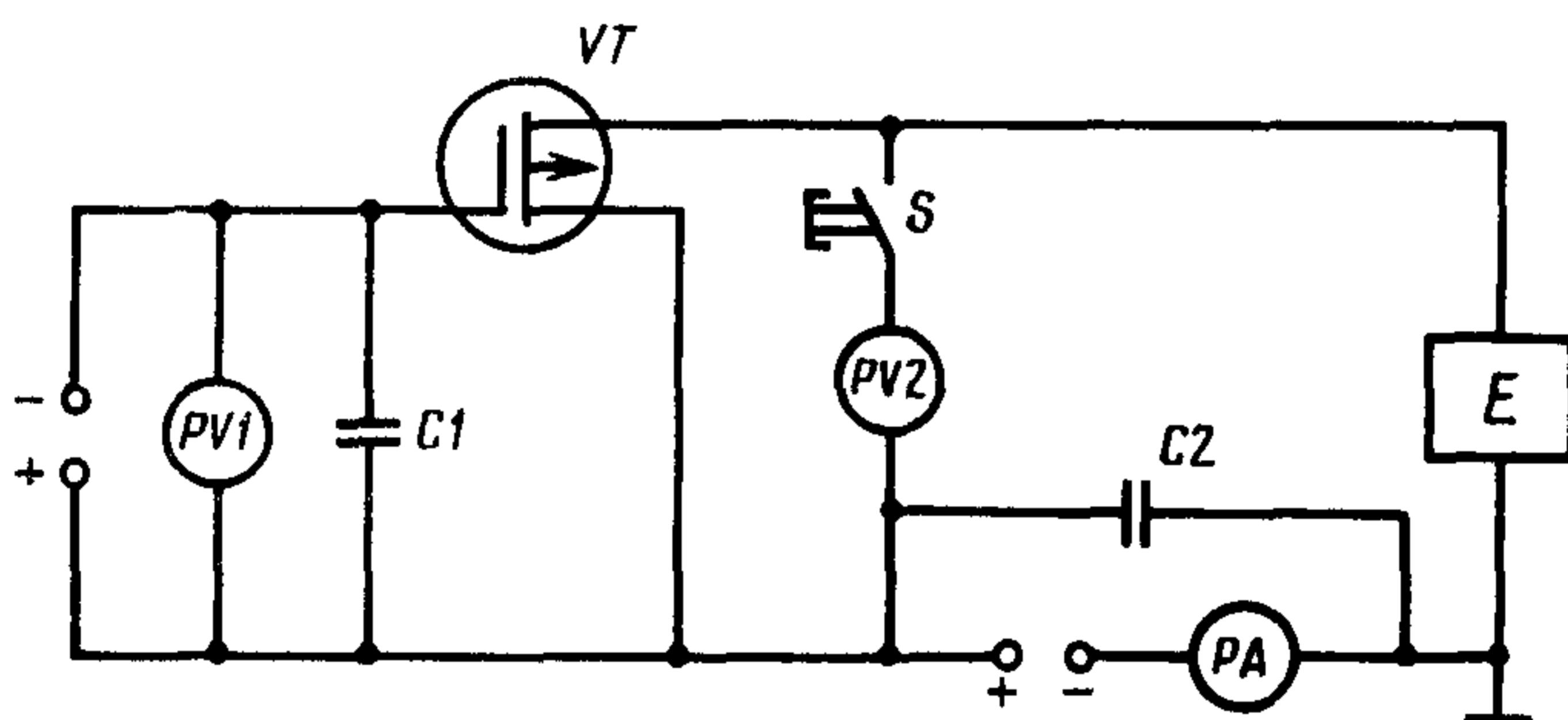
VT—измеряемый транзистор, S—переключатель PV1, PV2—измерители напряжения, C1, C2—конденсаторы E—измерительный мост
