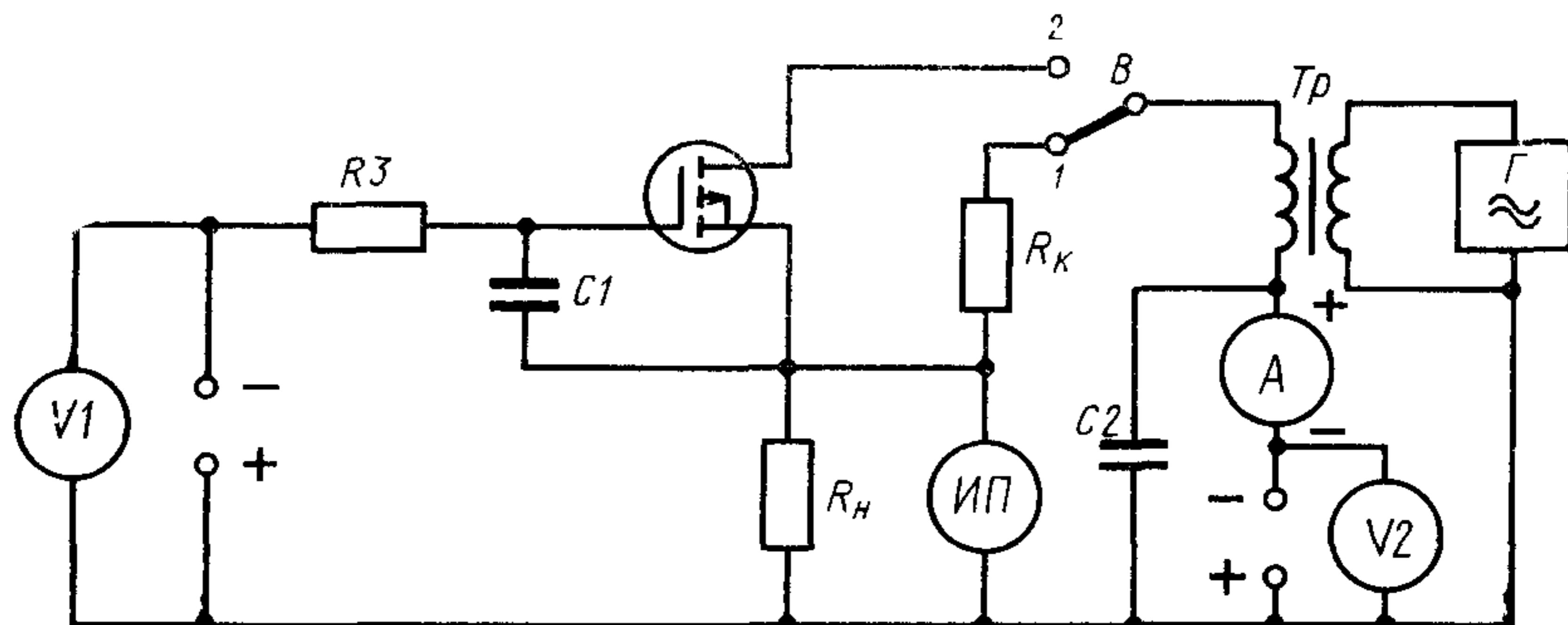
$\Gamma$  — генератор,  $R_3$ ,  $R_H$ ,  $R_K$  — резисторы;  $C_1$ ,  $C_2$  — конденсаторы,  $V_1$ ,  $V_2$ ,  $ИП$  — измерители напряжения,  $A$  — измеритель тока,  $T_p$  — трансформатор,  $B$  — переключатель.
