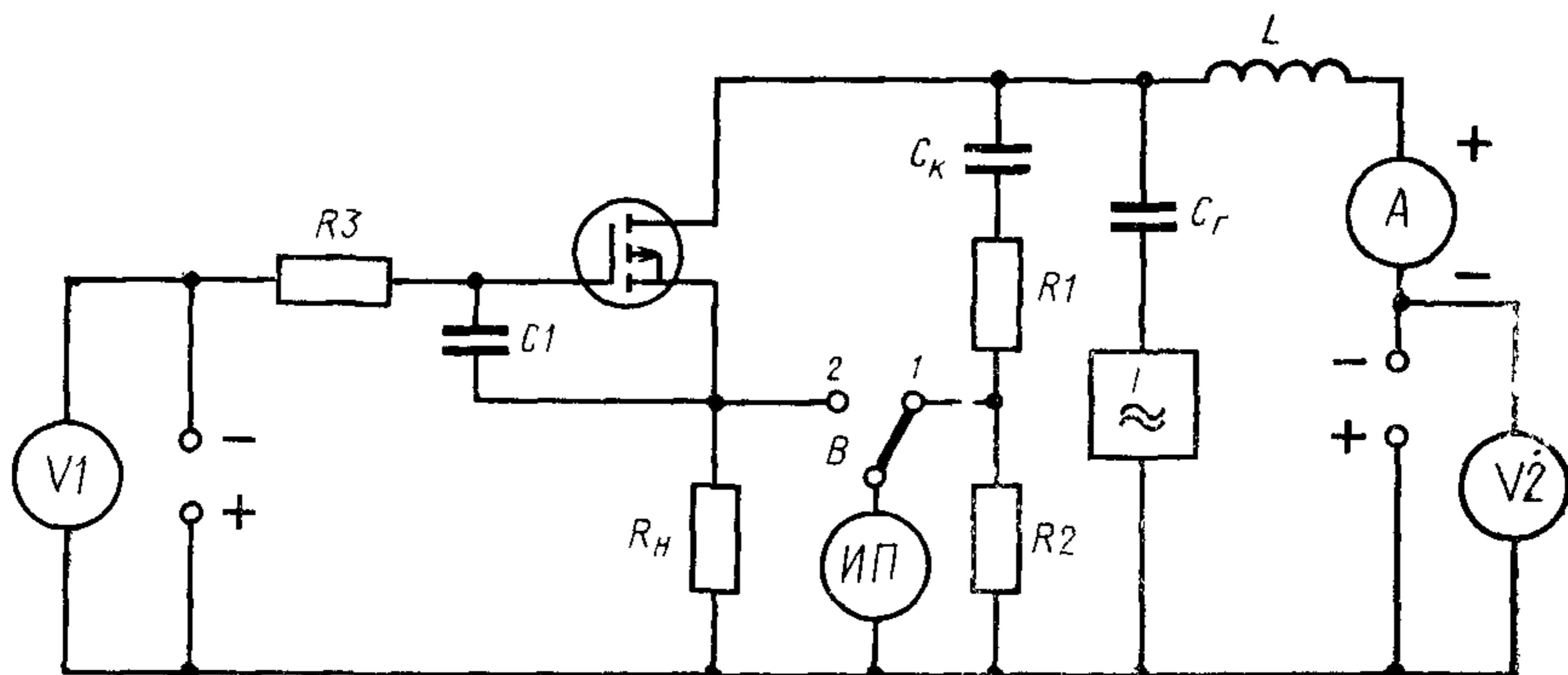
$\Gamma$ —генератор;  $R_1, R_2, R_3, R_n$ —резисторы,  $C_1, C_K, C_r$ —конденсаторы,  $L$ —дроссель,  $V_1, V_2$ , ИП—измерители напряжения, А—измеритель тока,  $B$ —переключатель
