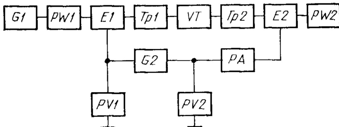
*G1*—генератор возбуждения; *PW1*—измеритель проходящей мощности; *E1*, *E2*—вводы питания; *Tr1*, *Tr2*—согласующие трансформаторы; *G2*—блок питания транзистора; *VT*—измеряемый транзистор с контактодержателем; *PW2*—измеритель выходной мощности; *PA*—измеритель постоянного тока стока; *PV1*, *PV2*—измерители постоянных напряжений на стоке и затворе
