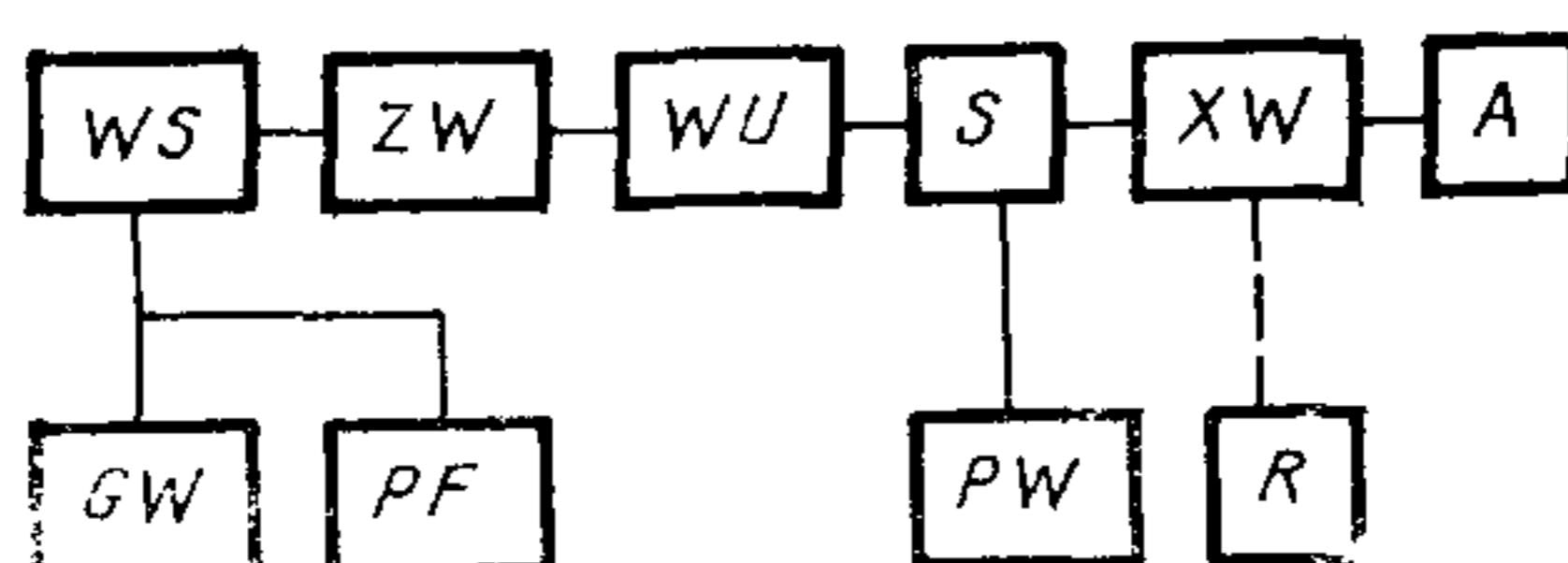
*GW*—генератор СВЧ мощности; *PF*—частотомер; *WS*—вентиль; *ZW*—фильтр СВЧ или другое устройство, обеспечивающее подавление шумов генератора *GW*; *WU*—переменный аттенюатор; *S*—переключатель СВЧ; *PW*—измеритель мощности; *XW*—измерительная диодная камера с диодом; *A*—усилитель промежуточной частоты; *R*—набор калибровочных резисторов
