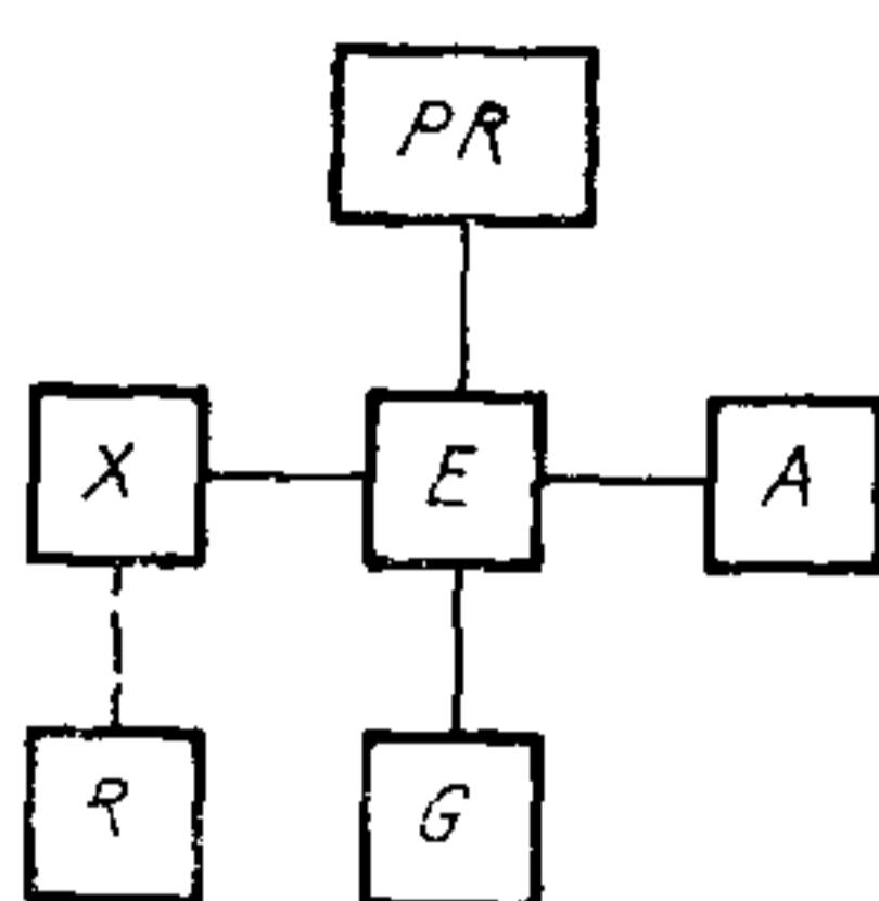
$X$ —контактное устройство с проверяемым диодом;  $R$ —набор калибровочных резисторов;  $PR$ —измеритель сопротивления,  $E$ —распределительный блок,  $G$ —источник постоянного тока смещения;  $A$ —усилитель
