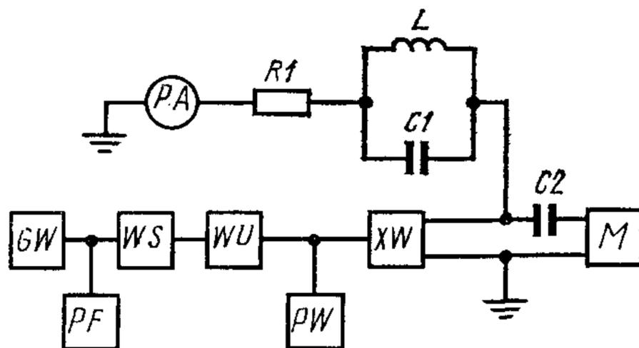
$GW$ —генератор СВЧ мощности;  $PF$ —частотомер;  $WS$ —ферритовый вентиль;  $WU$ —переменный attenuator;  $R1$ —добавочный резистор;  $PW$ —измеритель мощности;  $XW$ —измерительная диодная камера;  $L$ ,  $C1$ —резонансный контур;  $C2$ —разделительный конденсатор;  $M$ —мост переменного тока;  $PA$ —миллиамперметр.
