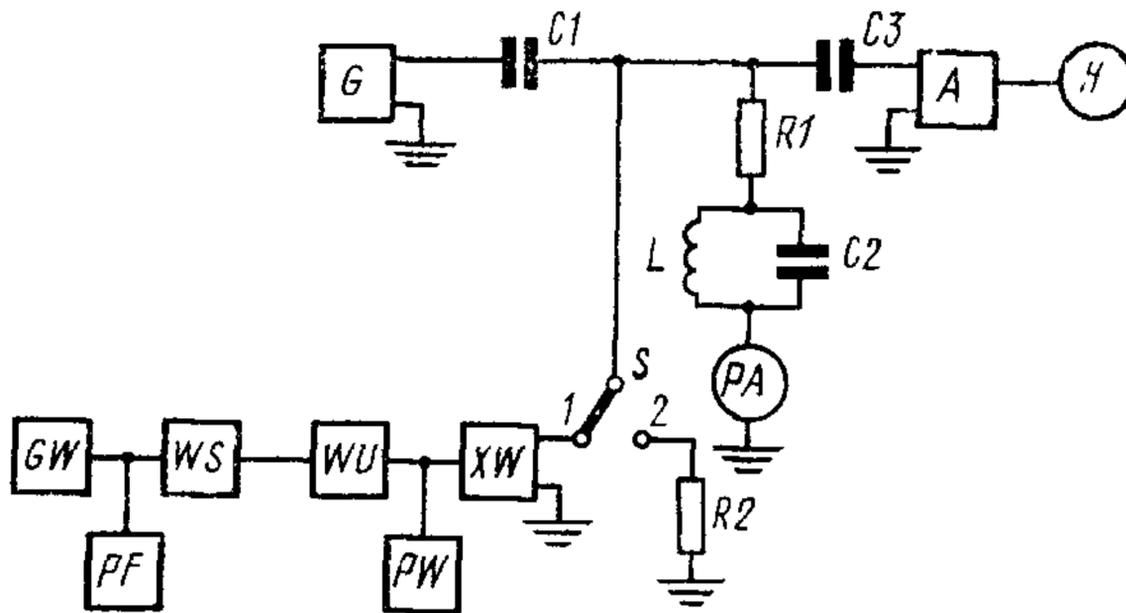
*GW*—генератор СВЧ мощности; *PF*—частотомер; *WS*—ферритовый вентиль; *G*—генератор переменного тока; *WU*—переменный аттенюатор; *PW*—измеритель мощности; *XW*—измерительная диодная камера; *R2*—калибровочный резистор; *C1*, *C3*—разделительные конденсаторы; *R1*—добавочный резистор; *L*, *C2*—резонансный контур; *A*—усилитель переменного тока; *H*—измерительный прибор; *PA*—миллиамперметр; *S*—переключатель.
