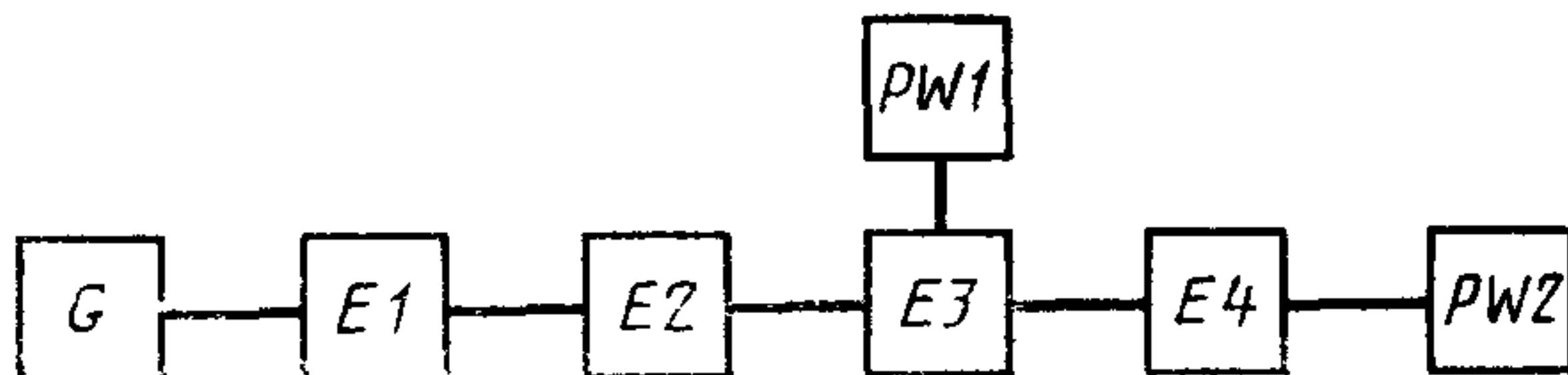
*G* — генератор СВЧ мощности; *E<sub>1</sub>* — вентиль; *E<sub>2</sub>* — переменный аттенюатор; *E<sub>3</sub>* — ответвитель; *E<sub>4</sub>* — диодная камера с ограничительным диодом; *PW<sub>1</sub>*, *PW<sub>2</sub>* — измерители мощности
