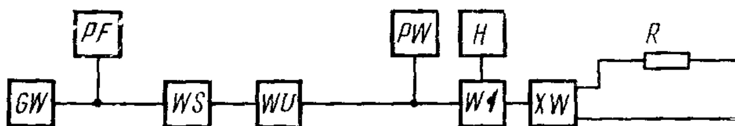
*GW*—генератор СВЧ мощности; *PF*—частотометр; *WS*—ферритовый вентиль; *WU*—переменный аттенюатор; *PW*—измеритель мощности; *H*—индикаторный прибор; *WI*—измерительная линия или рефлектометр; *XW*—измерительная диодная камера; *R*—резистор нагрузки по постоянному току.
