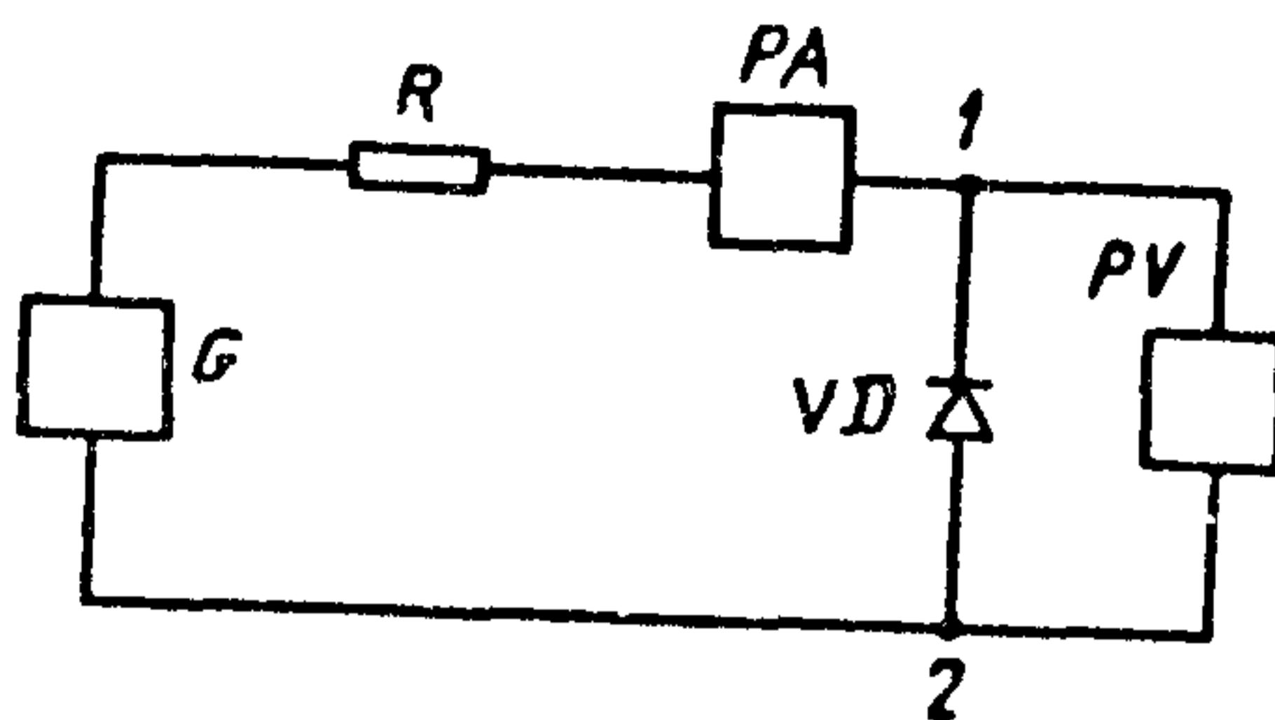
$G$  — генератор постоянного или пульсирующего напряжения;  $R$  — резистор;  $PA$  — измеритель тока;  $VD$  — испытуемый диод;
