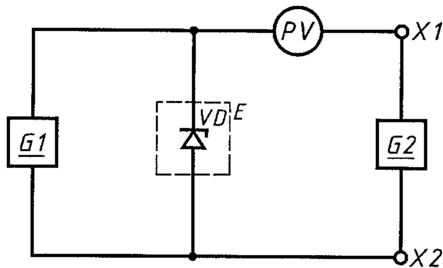
*G1* — генератор постоянного тока; *VD* — измеряемый стабилитрон; *E* — термостат; *PV* — измеритель постоянного тока;
