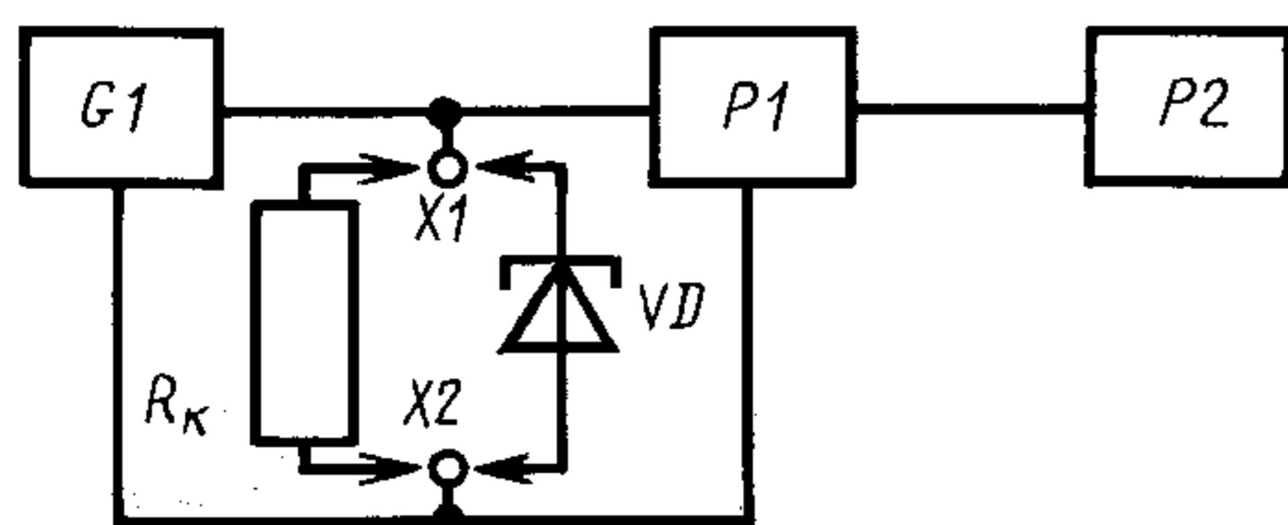
*G1* — генератор модулированных импульсов тока; *R<sub>k</sub>* — резистор калибровки; *VD* — туннельный диод; *X1* и *X2* — контакты подключения туннельного диода или резистора калибровки; *P1* — устройство выделения огибающей; *P2* — измерительный прибор
