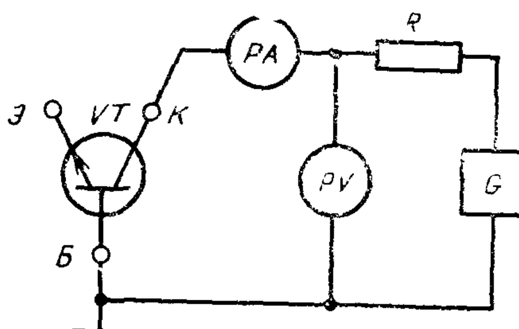
$VT$  — проверяемый транзистор,  $\mathcal{E}$  — эмиттер,  $K$  — коллектор,  $B$  — база,  $PA$  — измеритель постоянного тока,  $R$  — ограничительный резистор,  $PV$  — измеритель постоянного напряжения,  $G$  — источник постоянного напряжения
