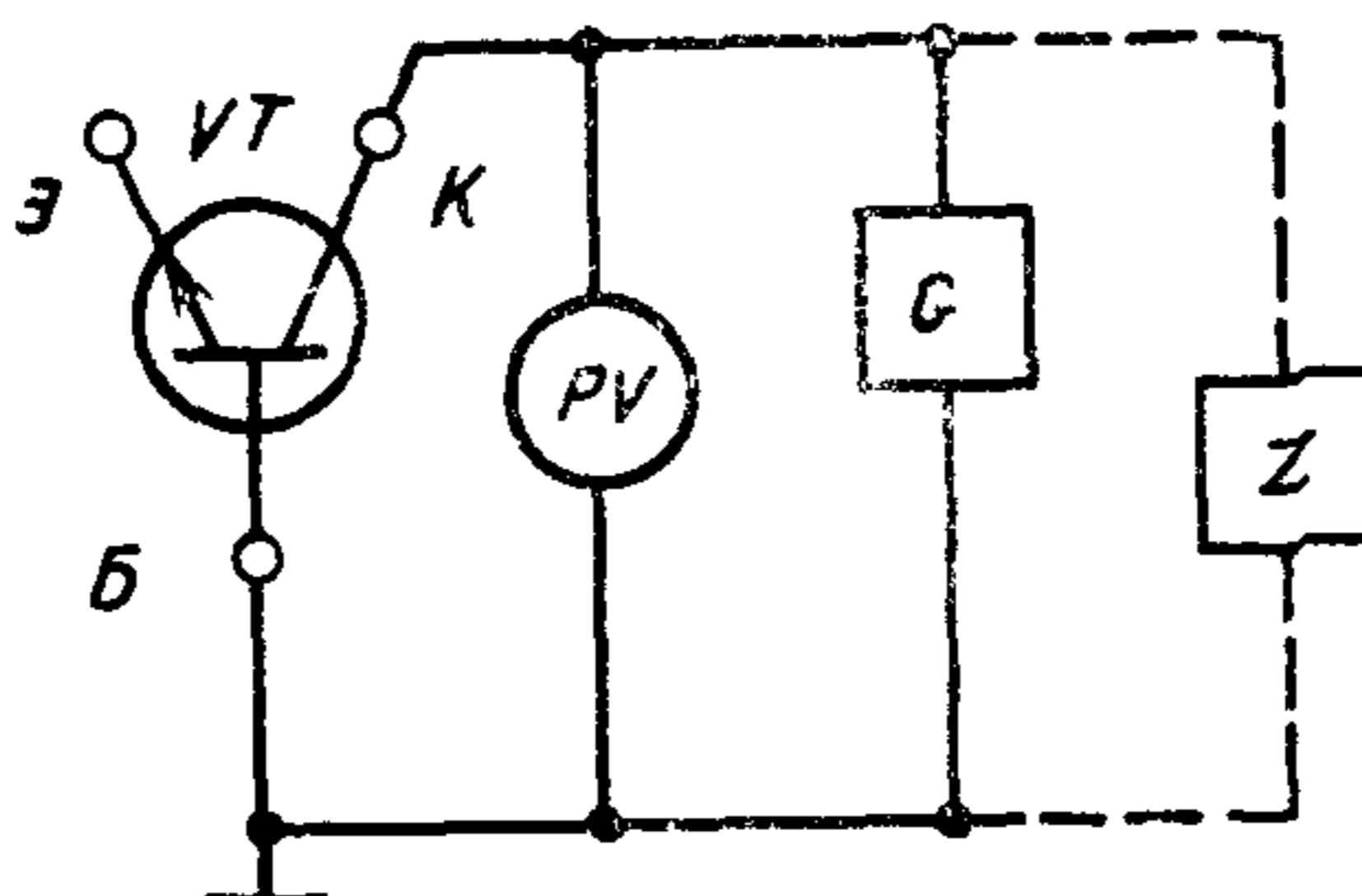
*VT* — проверяемый транзистор; *Э* — эмиттер; *К* — коллектор; *Б* — база, *PV* — измеритель постоянного или импульсного напряжения; *G* — генератор постоянного или импульсного тока; *Z* — ограничитель напряжения
