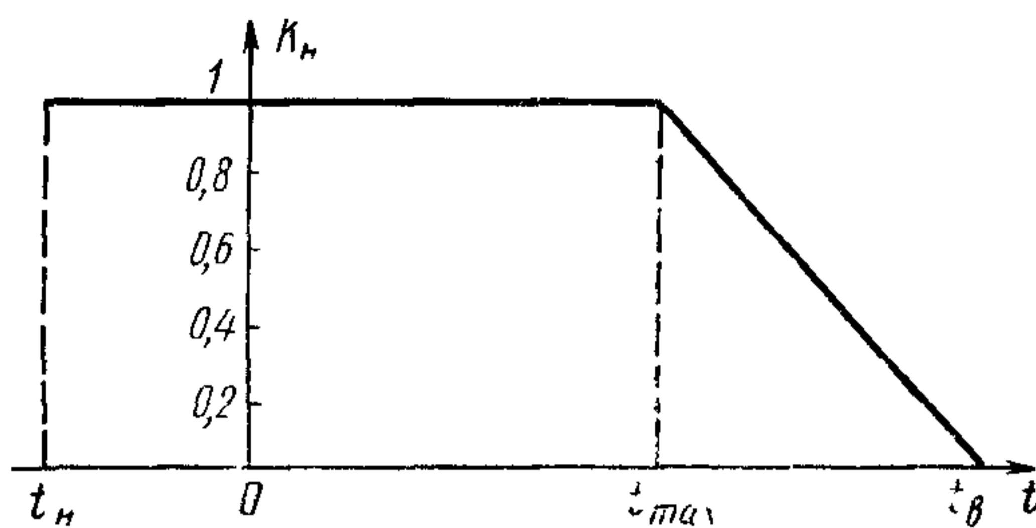
$P_t$  — допускаемая мощность рассеяния при заданной температуре, Вт;  $P_{ном}$  — номинальная мощность рассеяния, Вт;  $t_n$  — нижнее значение температуры окружающей среды, К ( $^{\circ}\text{C}$ );  $t_{max}$  — максимальное значение температуры окружающей среды для номинальной мощности рассеяния, К ( $^{\circ}\text{C}$ );  $t_v$  — верхнее значение температуры окружающей среды, К ( $^{\circ}\text{C}$ )
