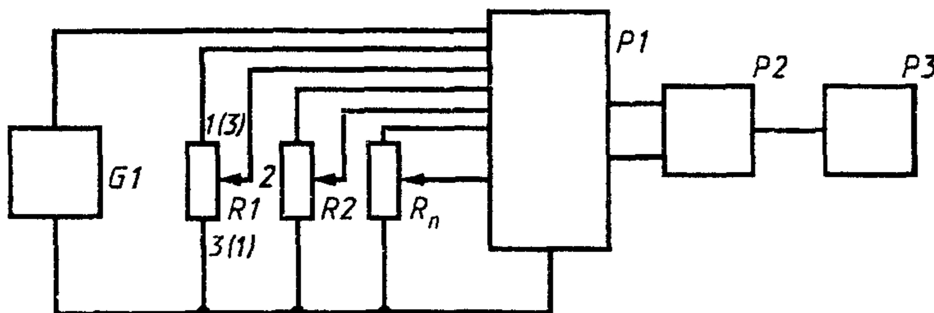
*G1 — источник напряжения постоянного тока, R1, R2 . . . Rn — элементы резистора, P1 — коммутатор, P2 — блок измерения напряжения, P3 — блок обработки и индикации информации*
