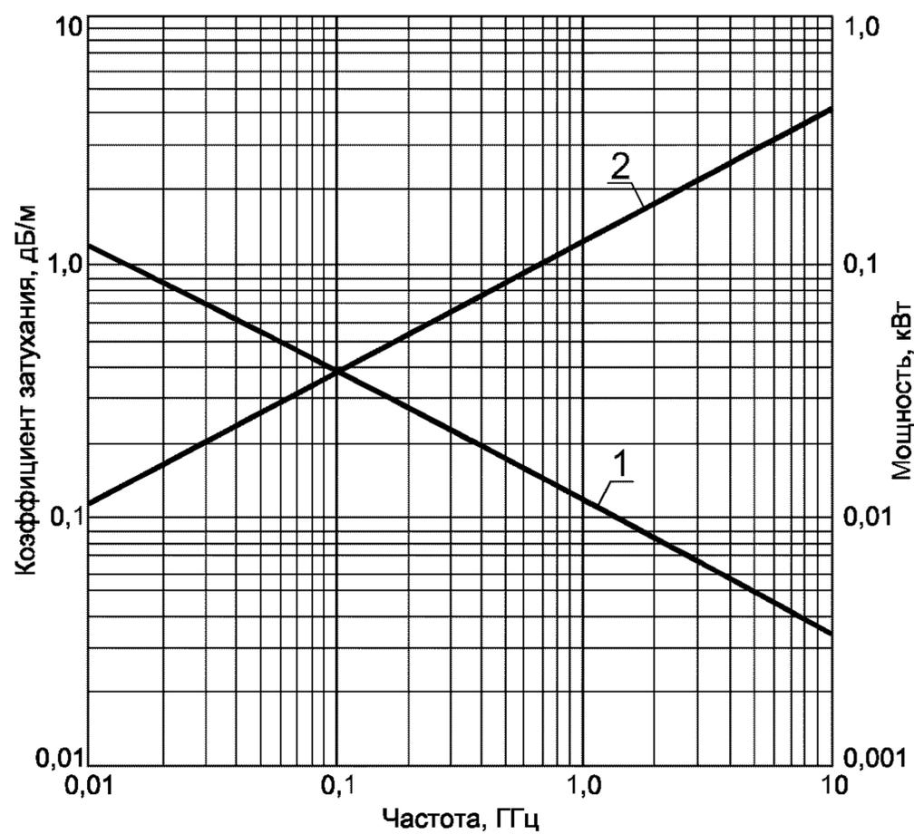
1—допустимая мощность  $P$  на входе при температуре  $40^\circ\text{C}$  и коэффициенте стоячей волны напряжения, равном 1; 2—коэффициент затухания  $\alpha$  при температуре  $20^\circ\text{C}$ .
