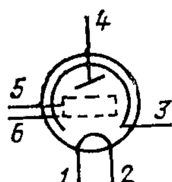
1, 2 — выводы накала инжектора; 3 — вывод внутрипроводящего покрытия;
