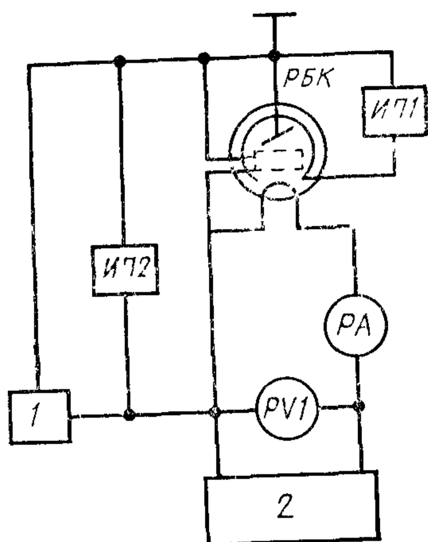
1 — источник питания инжекции; 2 — источник питания накала; ИП1 — измеритель тока инжекции; ИП2 — измеритель напряжения инжекции; РА — измеритель тока накала; PV1 — измеритель напряжения накала; РБК — рентгеновская бетатронная камера
