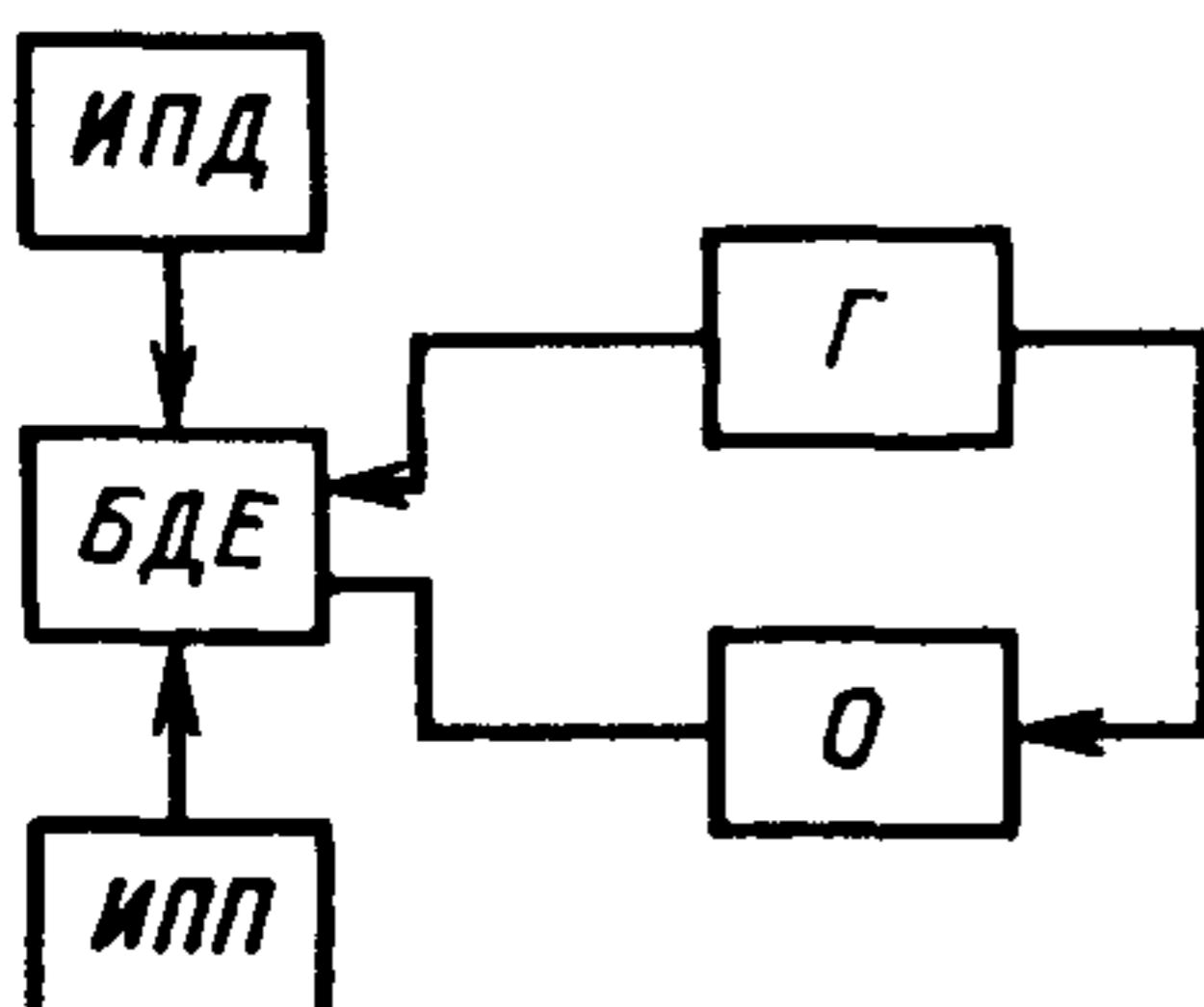
ИПД — источник питания детектора; БДЕ — блок детектирования; ИПП — источник питания предусилителя; Г — генератор; О — осциллограф
