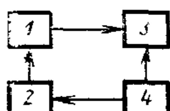
1—блок детектирования 2—источник питания ФЭУ, 3—прибор для измерения тока, 4—стабилизатор напряжения питания
