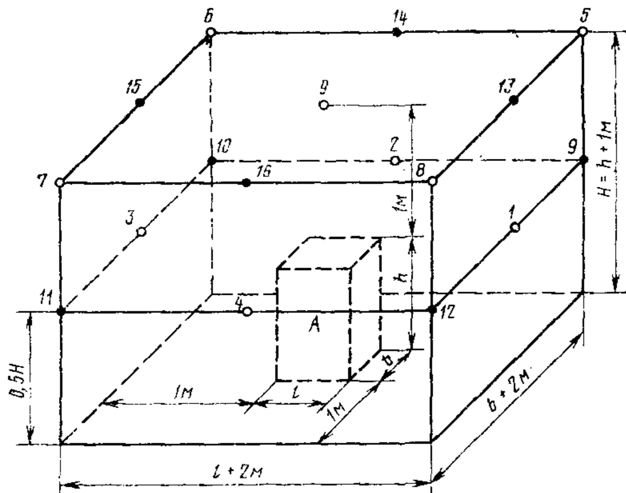
А—внешний контур кожуха; О—основные точки измерения; ●—дополнительные точки измерения.
