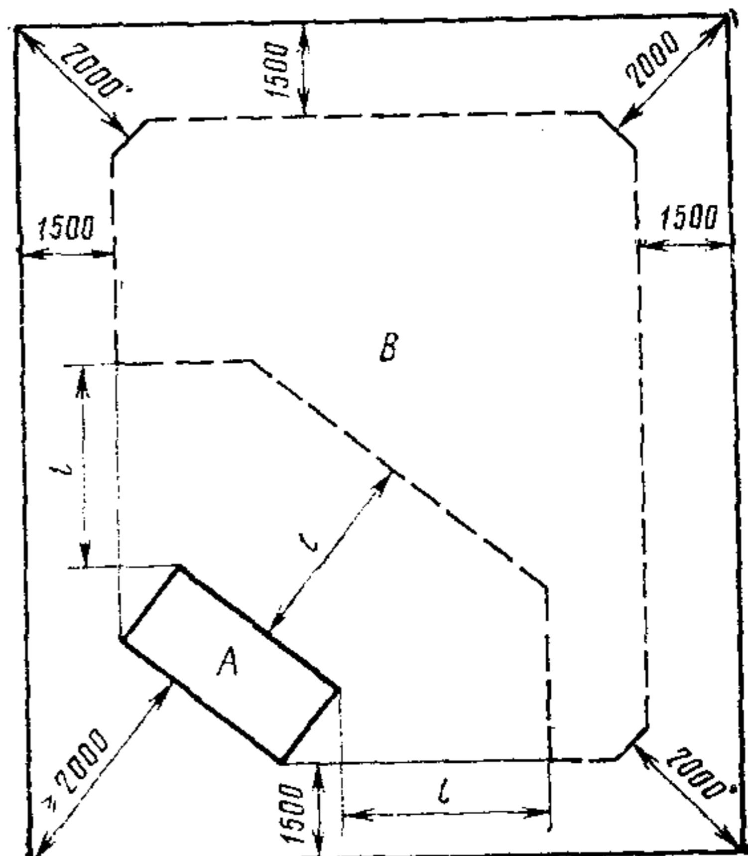
А—внешний контур кожуха; В—зона размещения точек измерения; l—наибольший линейный размер (длина, ширина или высота) кожуха.
